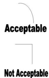
Top Ledge on Body 1 1/2" Roll Min.
